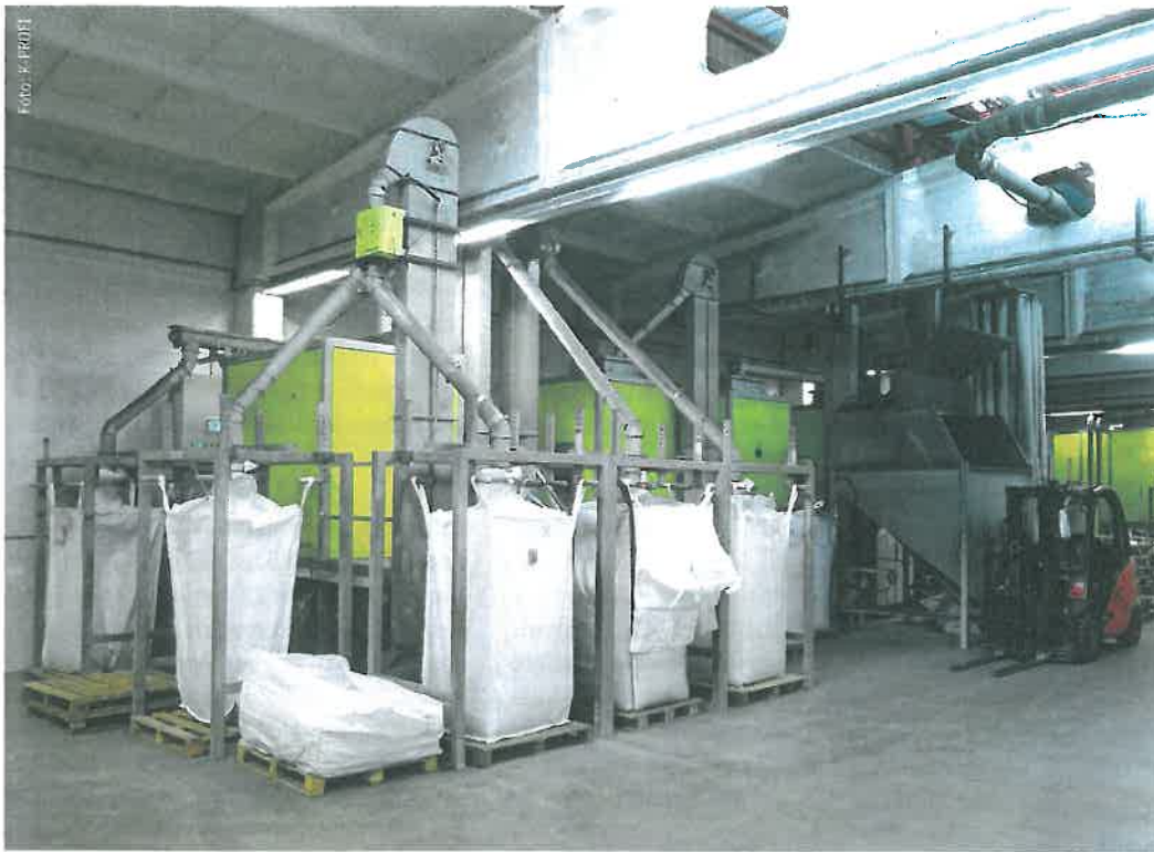
Aus der zweistufigen Trennung der Zielfraktion mithilfe elektrostatischer Kunststoff-Separatoren erhält Wersag mehr als die Hälfte der aufgegebenen Schrottmenge als zu 98,5 % sortenreine Zielfractionen ABS, PS und gefülltes PP.
